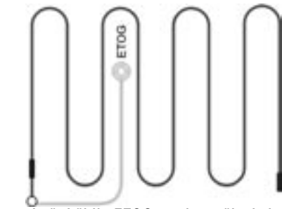
umístění čidla ETOG mezi smyčky kabelu
